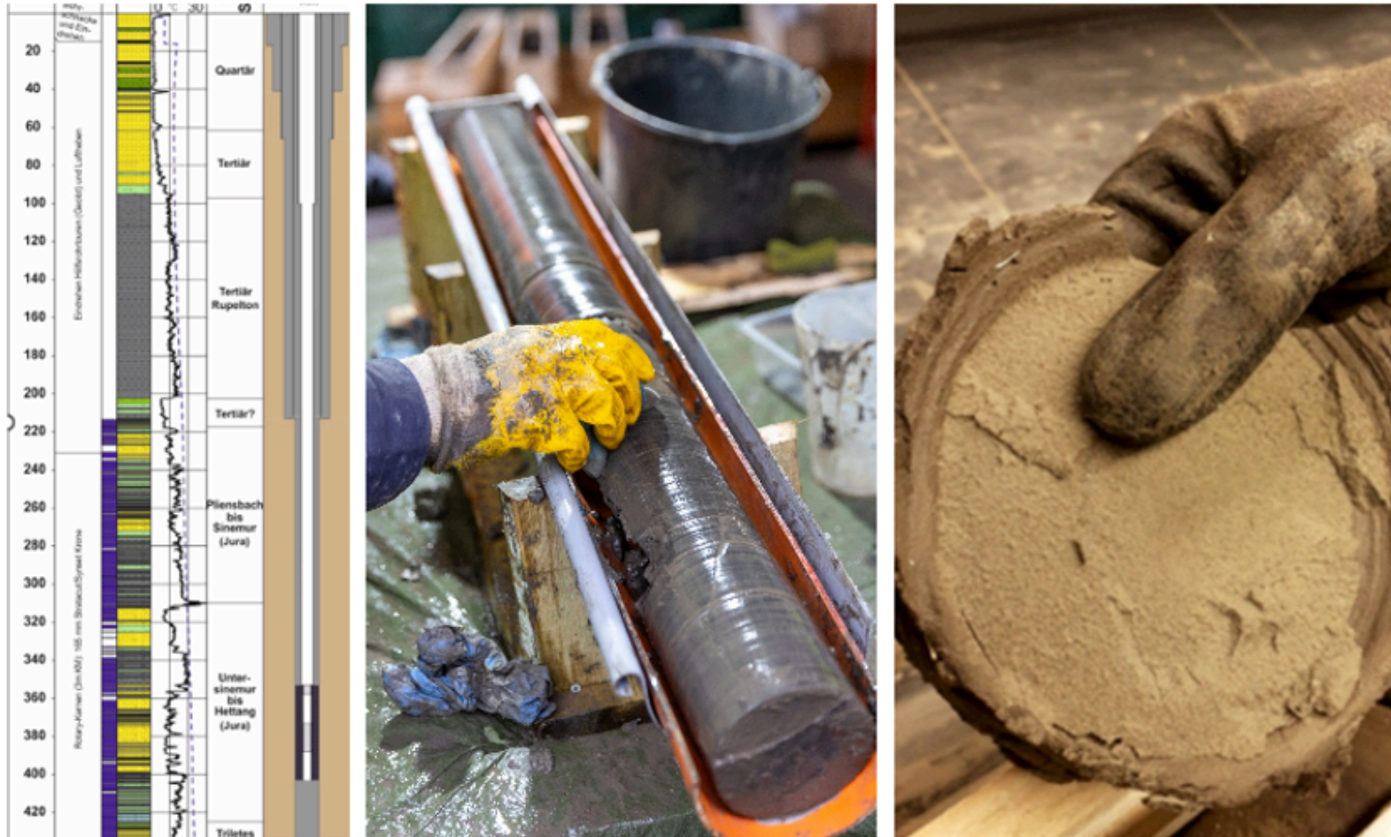
Bohrprofil Erkundungsbohrung / Bohrkern / Querschnitt eines Bohrkerns des Speichergesteins
